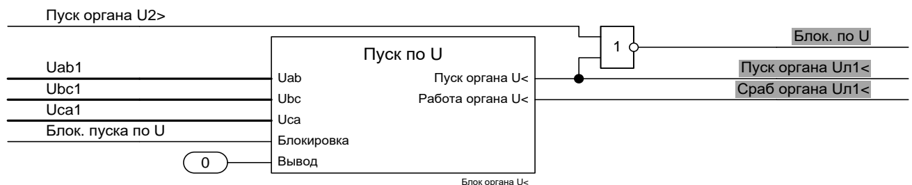
Рисунок 1.15 – Логическая схема пуска по напряжению
