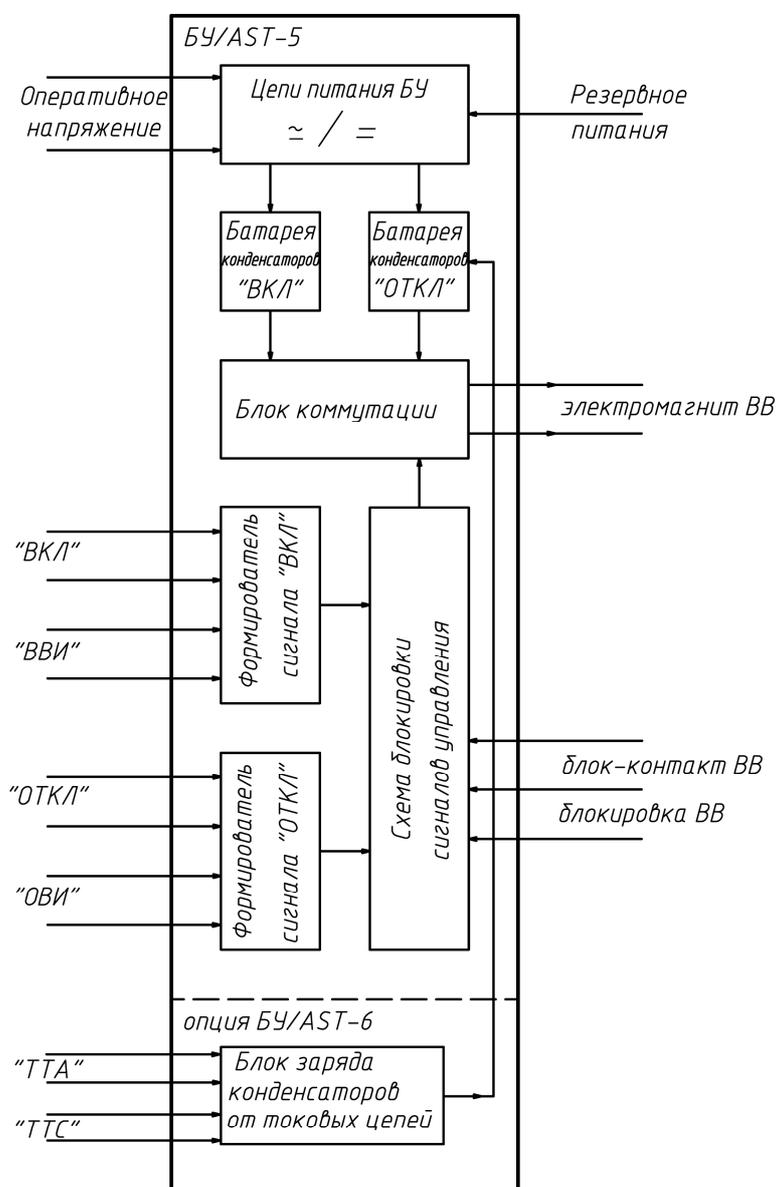
Рис. 1. Блок-схема БУ/AST-5.2 (6.2)
