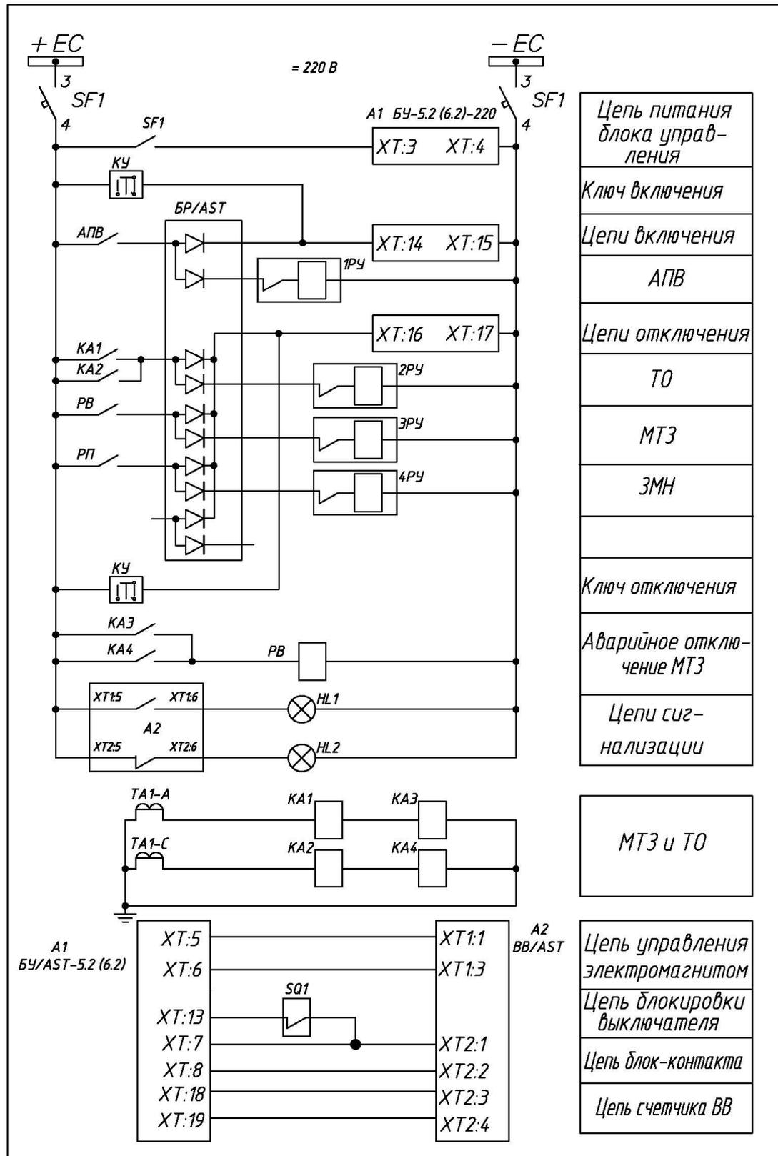
**Внимание!** Цепи управления электромагнитами вакуумного выключателя выпуска до 2012 года могут подключаться к другим контактам. При подключении необходимо пользоваться руководством по эксплуатации, поставляемым с выключателем и маркировкой разъемов, нанесенной на корпус.
