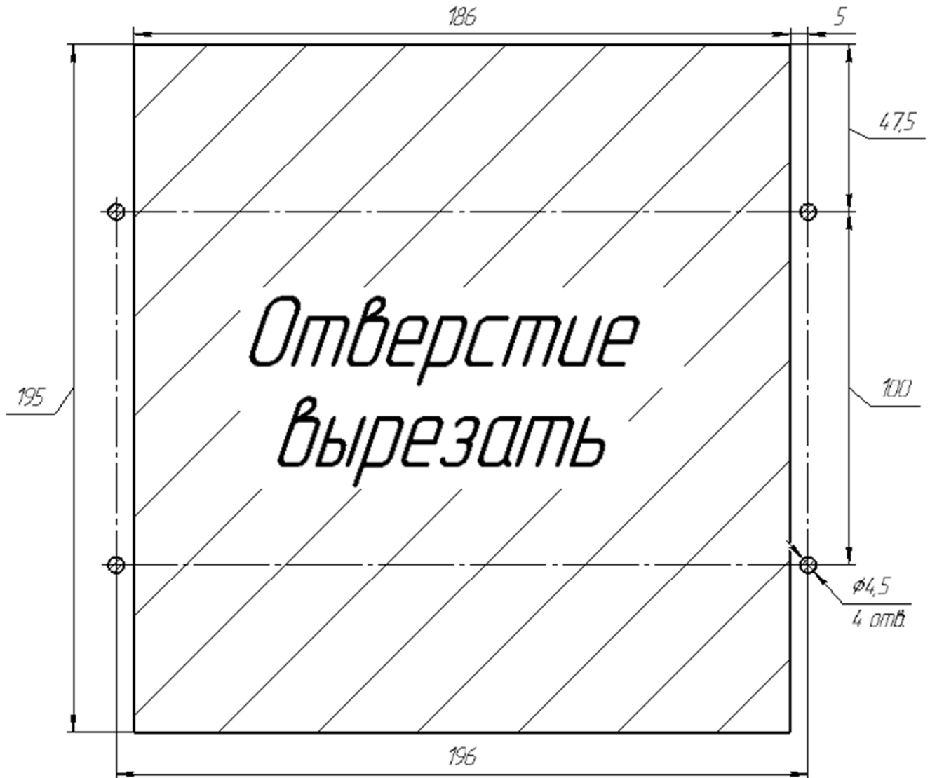
Схема отверстий для установки блока управления БУ-8
